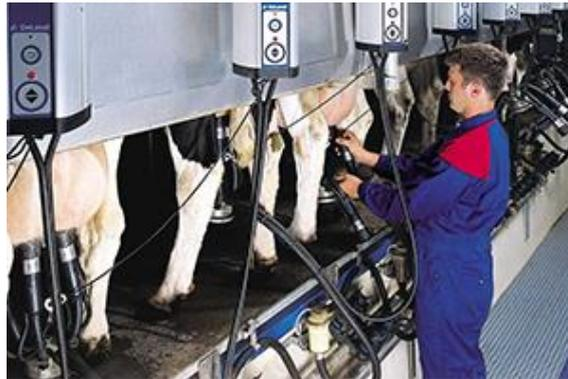
Abbildung 22: Side-by-Side Melkstand
