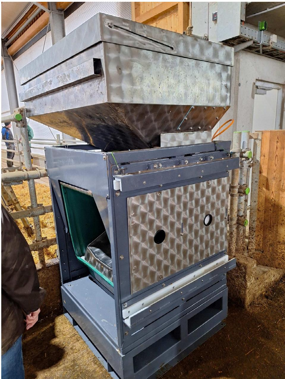
Abbildung 1: Greenfeeder für Methan- und CO<sub>2</sub> Messung bei Rinder
