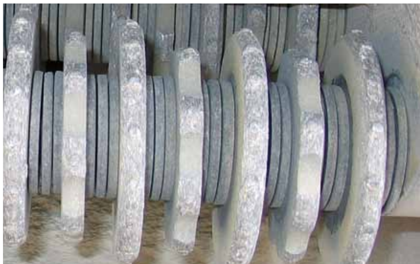
Abb. 2: Das Bearbeiten in Längsrichtung durch eine Kombination von Rund- und Achtkantlamellen ermöglicht ein gezieltes Rillieren und gleichzeitiges Aufrauen der dazwischen liegenden Flächen.
