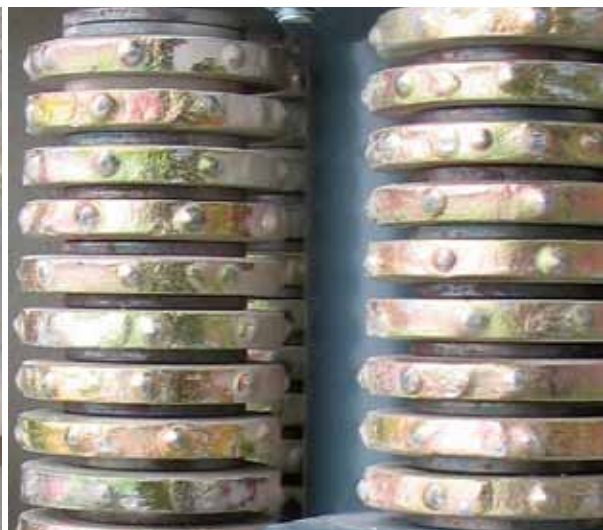
Abb. 3: Die Bearbeitung der restlichen Oberfläche in Querrichtung mit Rundlamellen ergibt eine feine Rillierung bei geringen Ausbrechungen.
