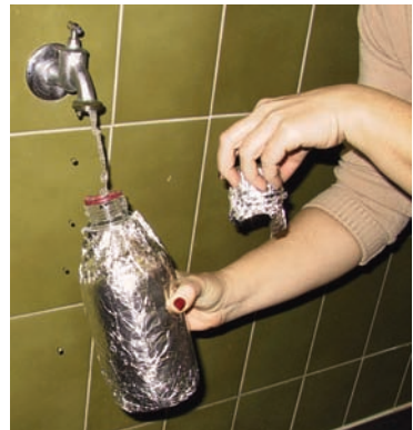
Abb. 25 a und b: Entnahme einer Trinkwasserprobe (Hahnentnahme) beim Verbraucher, © AGES
