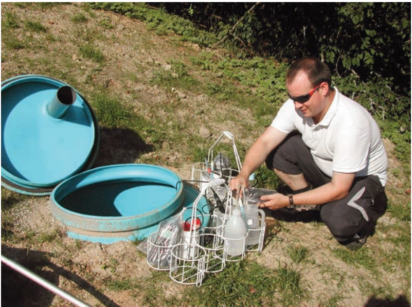
Abb. 24: Entnahme einer Trinkwasserprobe und Messungen vor Ort, © AGES
