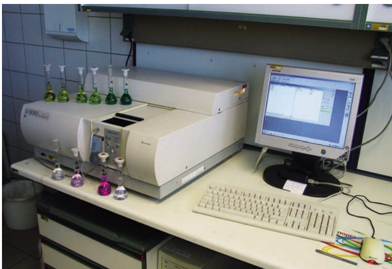
Abb. 28: Nitrit- und Ammoniumbestimmung im Labor mittels Spektralphotometers, © AGES
