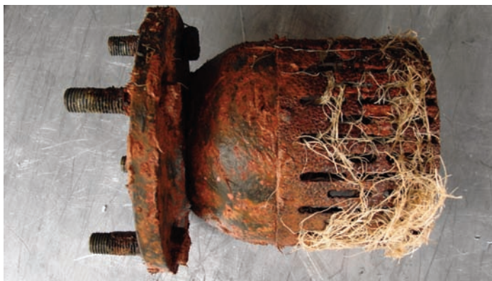
Abb. 19: So nicht! Rostiges und mit Wurzelwerk durchwachsenes Ablaufrohr, © Wallner Baumanagement
